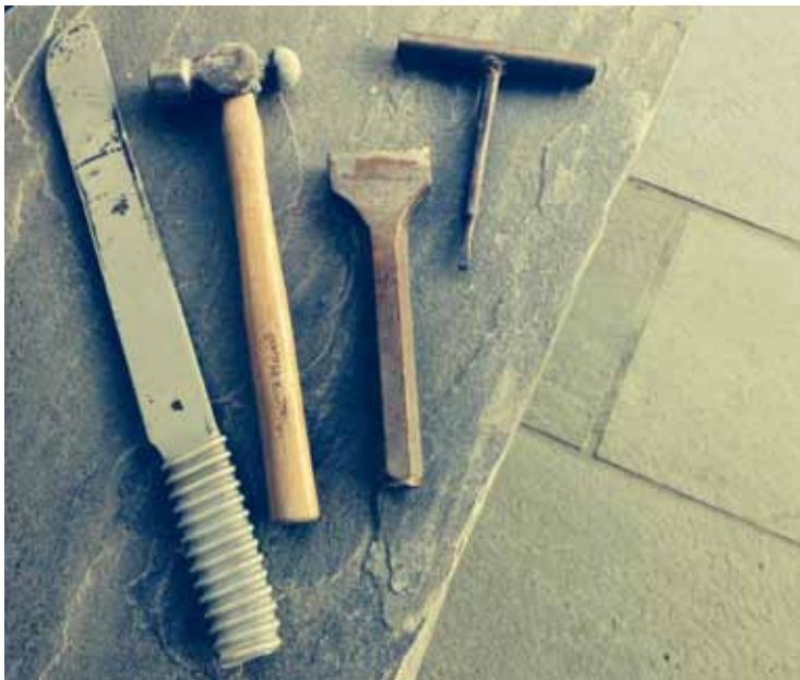
På bildet fra venstre til høyre: skiferkniv, kulehammer, meisel, rissel.
