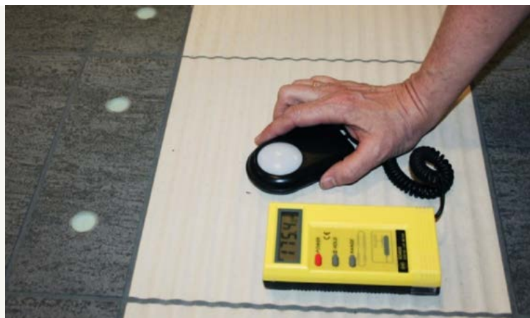
Figur 3: Et luxmeter gir mulighet å beregne luminanskontrast både på prøvefliser og på ferdig lagte flater.
