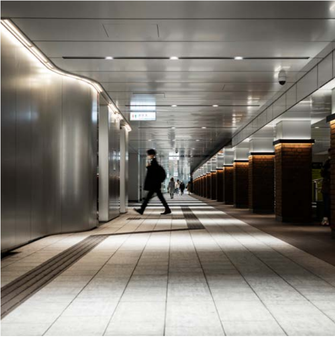
Figur 6 a og b: Fargevalget på ledelinjen på bildet til høyre er best synlig for en svaksynt. Men med så store kontraster som er her på bildet til venstre innfris lett kravene i TEK17 med en lys hovedfarge og mørk ledelinje.
