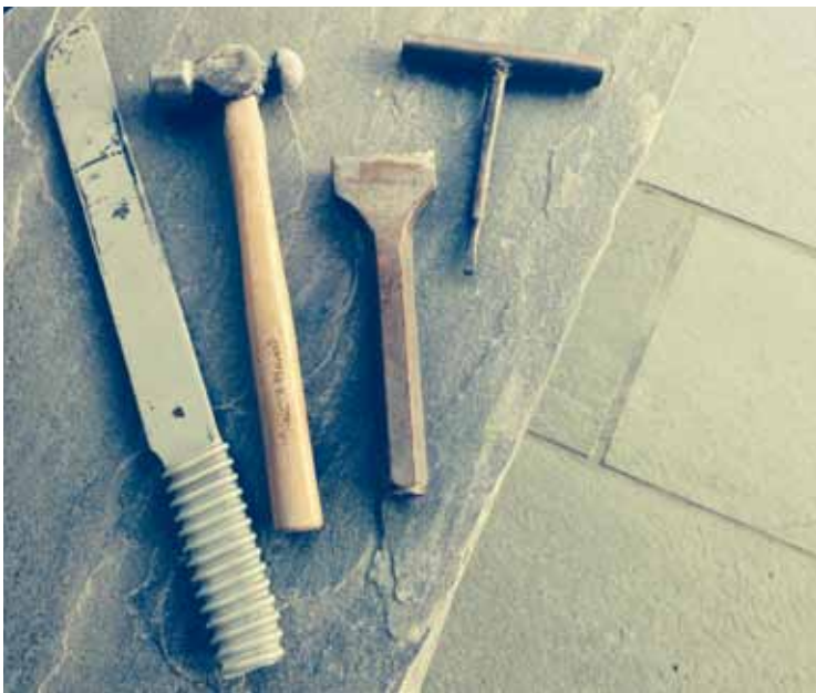
På bildet fra venstre til høyre: skiferkniv, kulehammer, meisel, risser.
